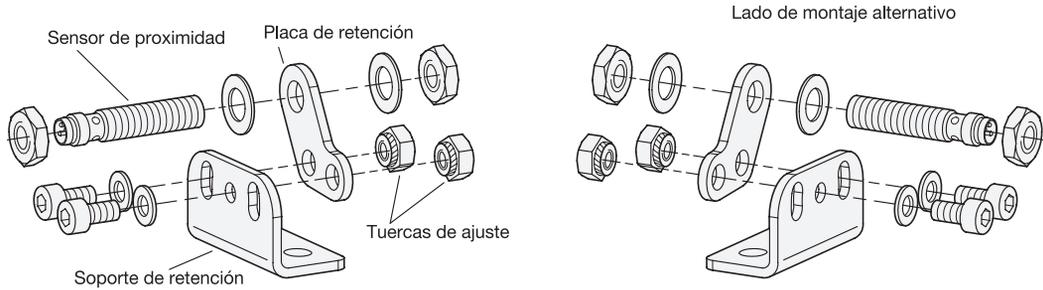
Los soportes de sensor se pueden montar en el lado izquierdo o el derecho de la brida de apriete. Para hacerlo, deben apretarse las tuercas de ajuste del lado izquierdo o el derecho de la placa de retención para asegurarlas contra rotación y pérdida. Ello facilita el posterior montaje del soporte de sensor y el ajuste del sensor. No se prevé un ulterior cambio del lado de montaje.
